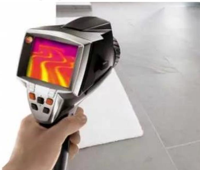
Рисунок 1 – Тепловизор Testo 875 li
