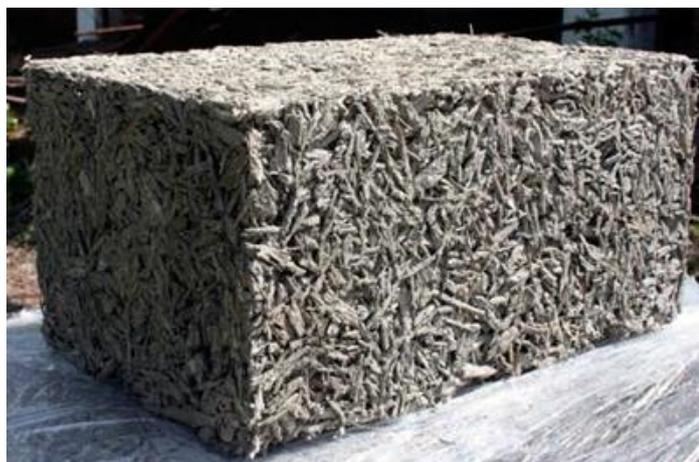
Рисунок 2 – Арболитный блок
