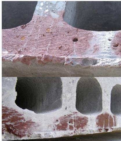
Рисунок 2 - Проскальзывание арматуры после резки
