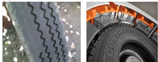
Рисунок 1 – Повреждение и восстановление покрытия шины
