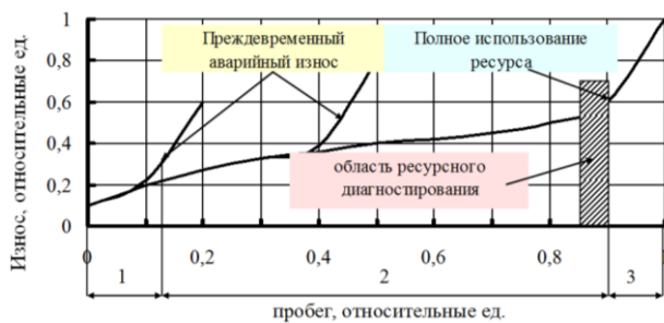
Рисунок 1 – Кривая износа элементов станка в период эксплуатации
