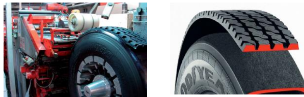
Рисунок 2 – Наложение протектора при восстановлении
