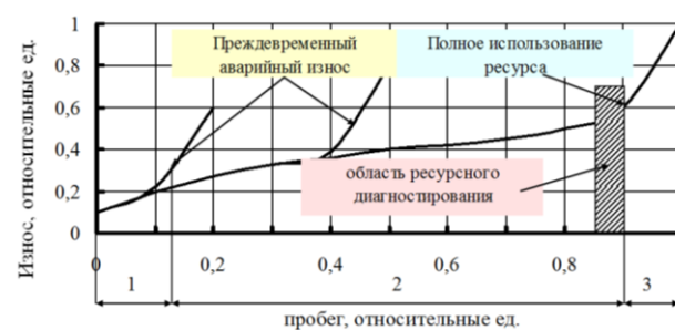
Рисунок 1 – Кривая износа элементов станка в период эксплуатации
