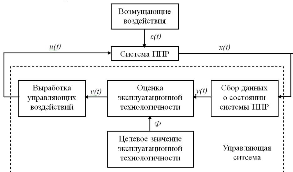
Рисунок 2 – Структурная схема компьютеризированного управления в системе ППР по критерию эксплуатационной технологичности
