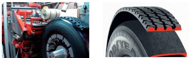
Рисунок 2 – Наложение протектора при восстановлении
