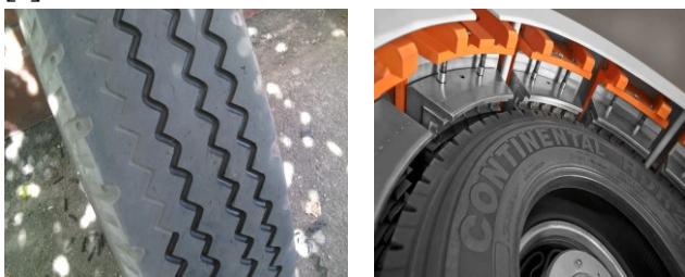
Рисунок 1 – Повреждение и восстановление покрытия шины
