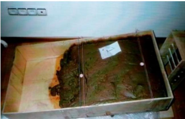
Рисунок 3 - Смещения марок, установленных на поверхности оползня: а) подготовка опыта при наличии перегородки; б) перегородка убрана; угол наклона лотка  $\alpha_1=8,62^\circ$
