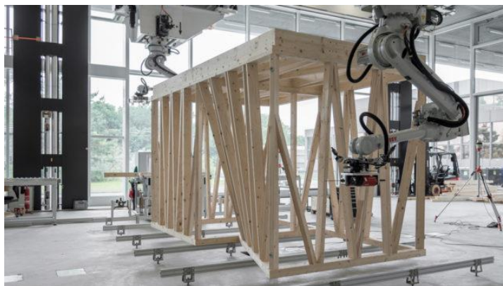
Рисунок 2 – «Метод пространственной сборки древесины (STA)», Цюрих, Швейцария
