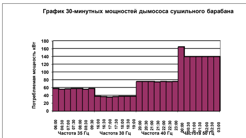
Рисунок 4 – Экспериментальные данные о потреблении электроэнергии дымососом при частотном регулировании
