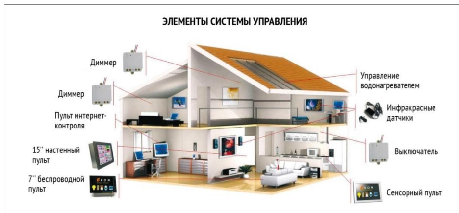
Рисунок 2 - Элементы системы управления «Умный дом»
