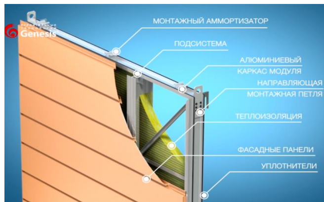
Рисунок 1 – Составляющие стенового модуля системы G-tech
