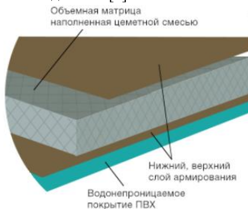
Рисунок 1 – Конструкция бетонного полотна
