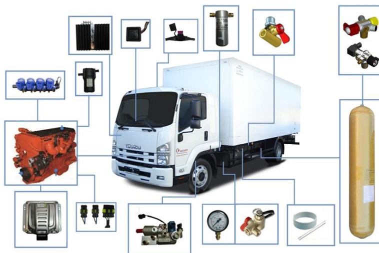
Установка газобаллонного оборудования на дизельный двигатель имеет ряд преимуществ:
