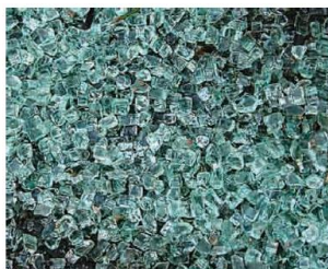
Рис. 3. Пример разрушения закаленного стекла.
