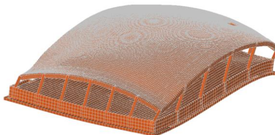
Рисунок 2 - Первая крутильная форма колебаний пролетного строения.
