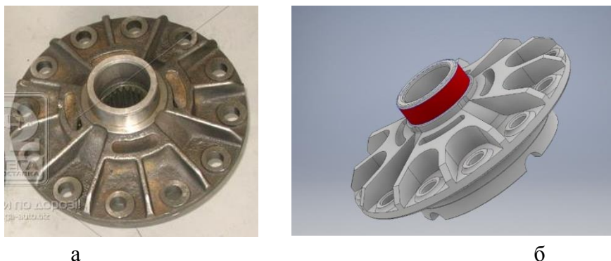
Рисунок 1 - Чашка дифференциала грузового автомобиля: а – фотография детали; б – геометрическая модель детали
