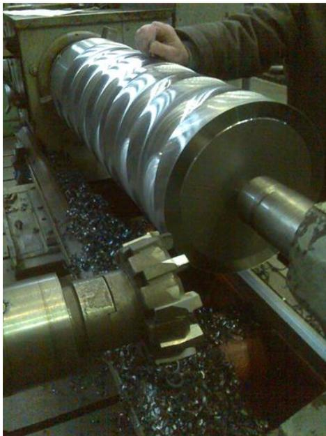
Рисунок 1 - Фрезерование ковального вала
