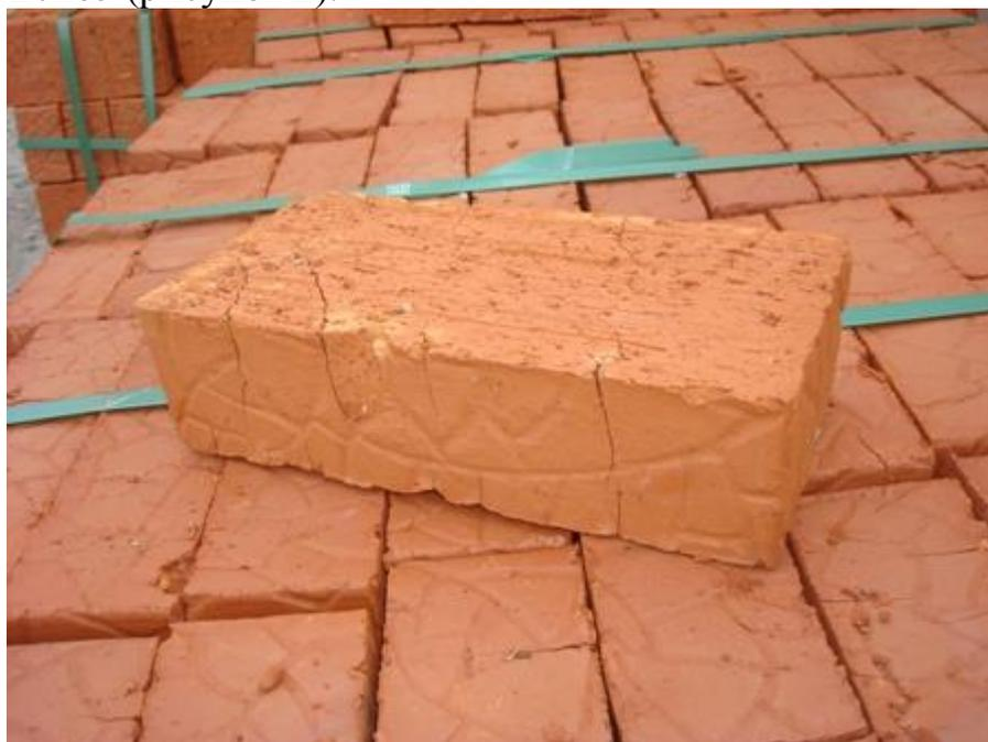
Рисунок 2 – Образец испытаний - кирпич керамический 250x120x65 мм
