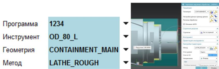
Рисунок 3 – Создание черновой токарной обработки в главном шпинделе
