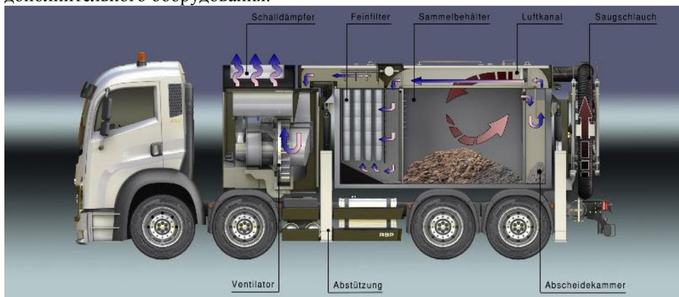
Рисунок 1 – Схема вакуумного экскаватора
