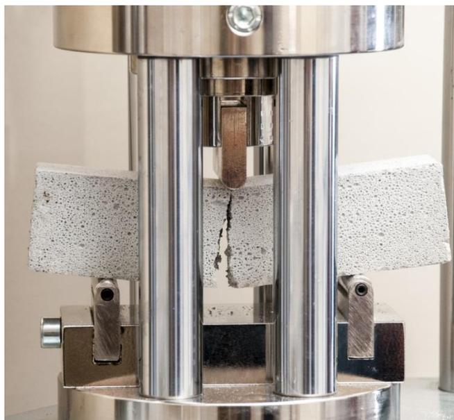
Рисунок 2 – Исследование образца геополимерного бетона
