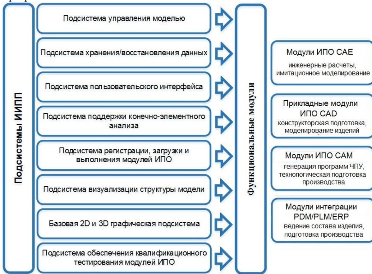
Рисунок 1 – Структура ИИПП, разрабатываемой в рамках проекта «Гербарий»
