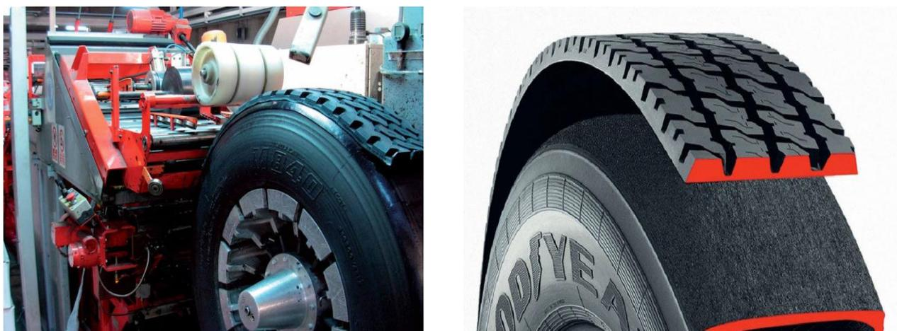
Рисунок 2 – Наложение протектора при восстановлении
