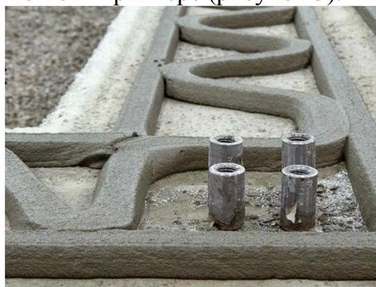
Рисунок 3 – Изготовление геополимерного бетона мобильном на 3D принтере
