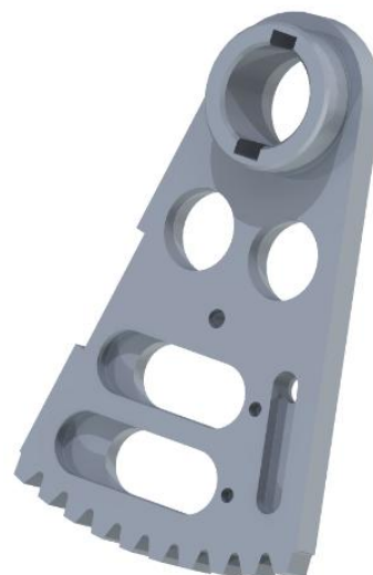
Рисунок 4 – Чертеж и трехмерная модель детали «Сектор зубчатый»
