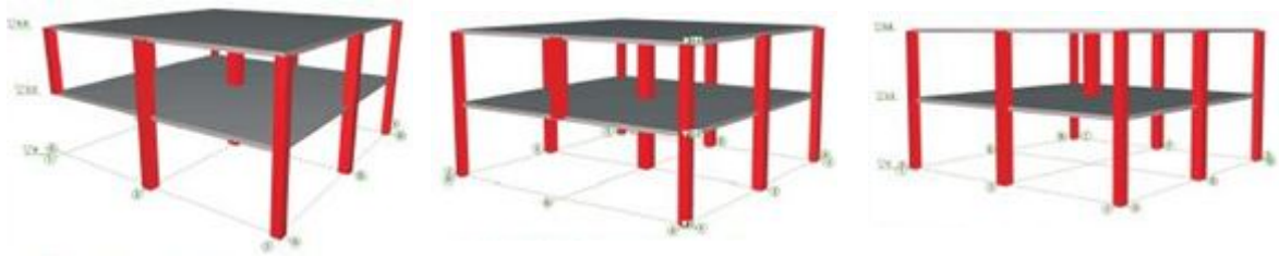
Рисунок 3 – Перераспределение нагрузок на опоры
