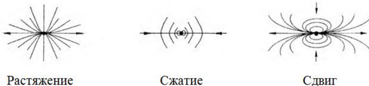
Рисунок 1 – Расположение и форма трещин при различных видах нагружения
