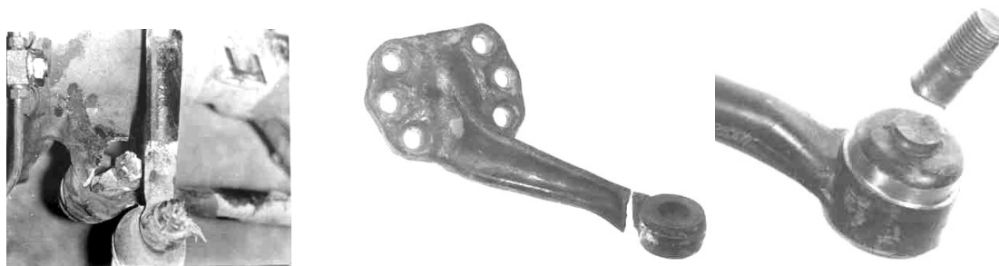
Рисунок 2 – Поломка рычагов поворотного кулака и стержня шарового пальца
