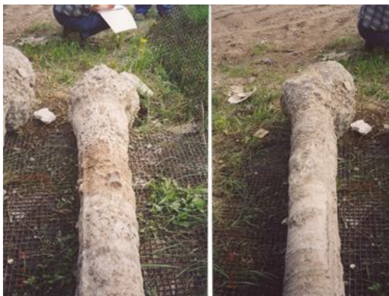
Рисунок 1 - Извлеченные сваи с камуфлетным уширением [4]
