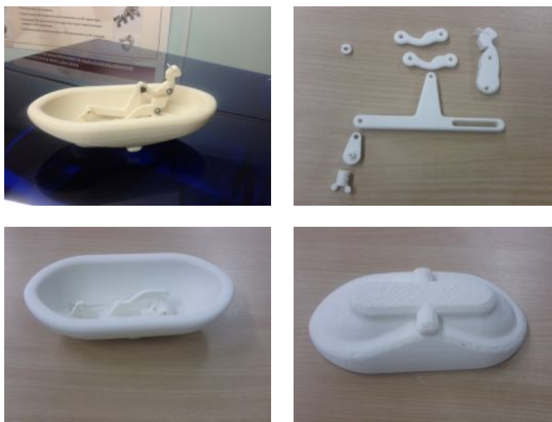
Рисунок 4 – Изготовленный методом 3D-печати кулисный механизм игрушечного гребца
